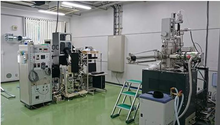
図 1.24: PLD 装置（2 台、奥）とスパッタ装置（手前）
