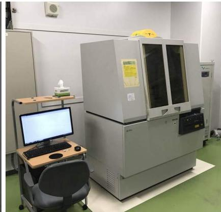
図 1.25: 薄膜用 4 軸 X 線回折装置
