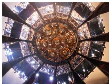
図 1.1: CANDLES III システムの内部写真。光電子増倍管と、光の収集効率を改善するためのライトパイプシステムである。本年度は、このライトパイプシステムの性能評価を行なった。
