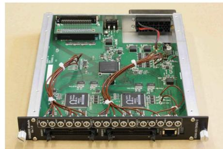
図 1.22: MPPC からの信号読み出し用 ASIC, ASIC 制御およびデータ通信用 FPGA, MPPC へのバイアス電源などを実装した基板。
