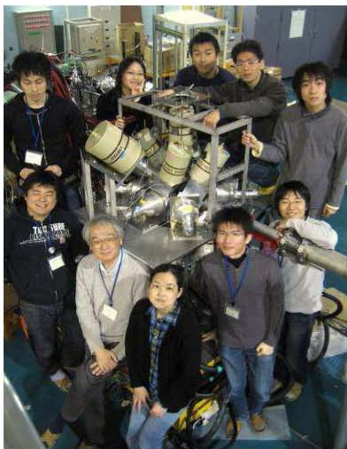
図 RCNP 実験におけるガンマ線検出のためのゲルマニウム検出器ボール。
