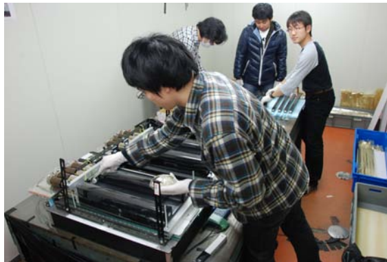
図 1.11: CsI 結晶の性能の全数検査
