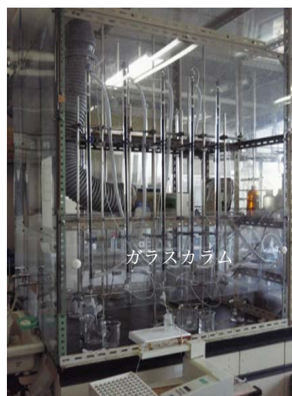
図 1.2: ^{48}\text{Ca} 濃縮テストのためのセットアップ。複数のガラスカラムにクラウンエーテル樹脂を充填して実験を行なう。
