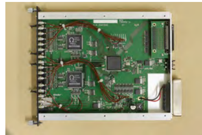
図 1.26: MPPC からの信号読み出し用 ASIC ,ASIC 制御およびデータ通信用 FPGA , MPPC へのバイアス電源などを実装した基板。
