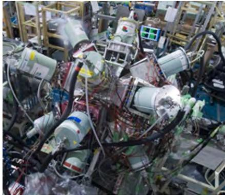
図 1.3: RCNP に設置されているガンマ線検出器アレイ CAGRA。
