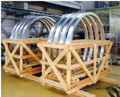
図 1.1: 鍛造で作られた、精密加工前の特殊アルミ合金のリング
