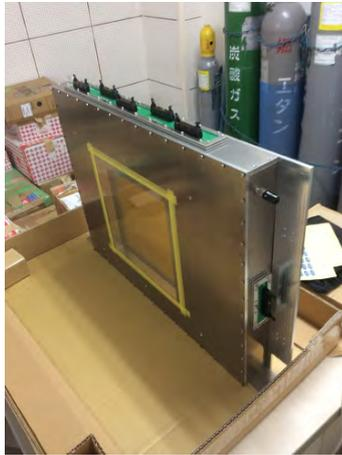
図 1.3: MWPC プロトタイプ検出器
