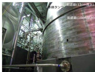
図 1.2: CANDLES III システムに導入している  $\gamma$  線遮蔽システム。中性子捕獲からの  $\gamma$  線遮蔽を遮蔽するために設置する。鉛の厚みは 10~12cm。
