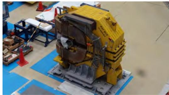
図 1.4: スペクトロメーター用電磁石
