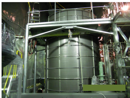
図 1.1: CANDLES III システムに導入している \gamma 線遮蔽システム。中性子捕獲からの \gamma 線を遮蔽するために設置する。写真は、最上部まで遮蔽材を設置した状態の様子。鉛の厚みは 10~12cm。
