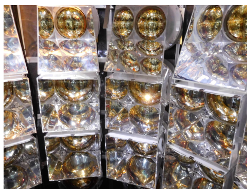
図 1.2: CANDLES III システムに導入している光電子増倍管とライトパイプ。写真に映っているのは、3 段分の光電子増倍管。光電子増倍管の丸い光電面が、ライトパイプの内側に反射して映っているのがわかる。最上段の光電子増倍管の光電面径は 10 インチで、2 段目以降は 13 インチ。
