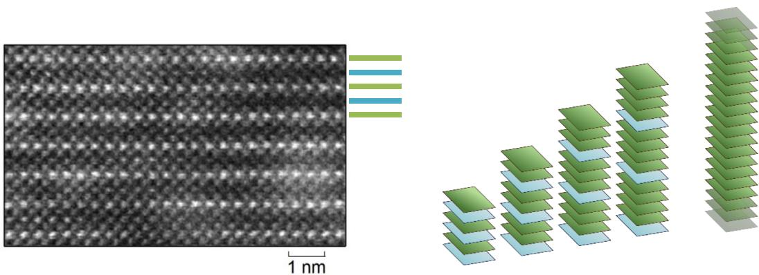
(左)チタン酸化物とイリジウム酸化物を一層ずつ交互に積層した試料の透過電子顕微鏡像。(右)異種物質の積層による連続的次元性制御。
