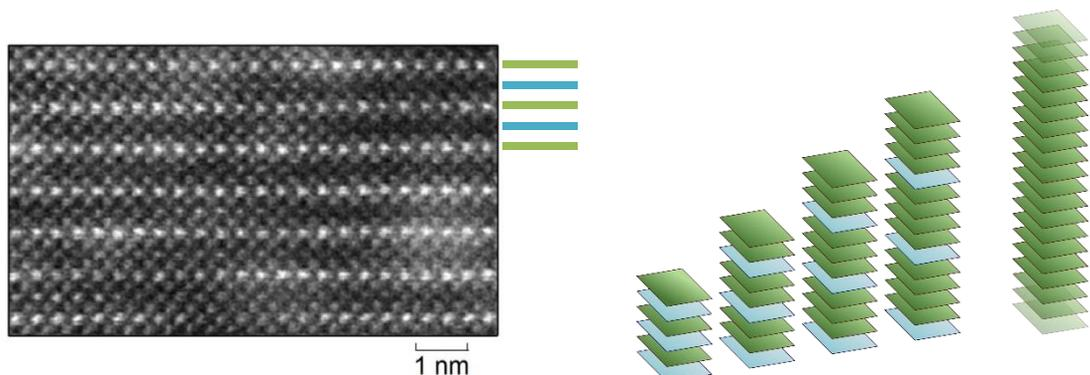
(左)チタン酸化物とイリジウム酸化物を一層ずつ交互に積層した試料の透過電子顕微鏡像。(右)異種物質の積層による連続的次元性制御。
