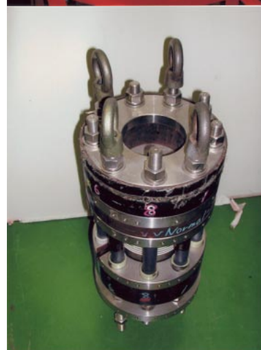
超強磁場マグネットの外観(上)と多層コイル部分(下)
