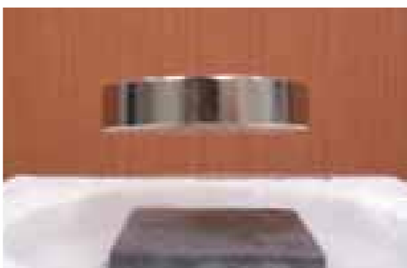
●銅酸化物超伝導体に磁場を捕えられ、宙に浮く永久磁石
